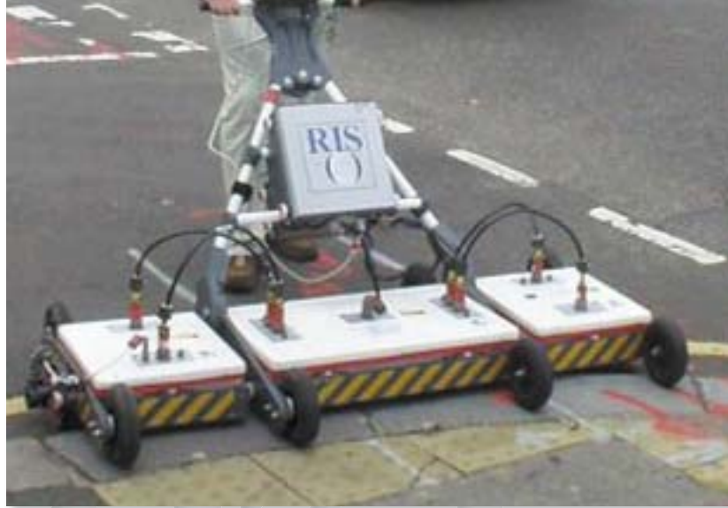
Sistema georadar per mappatura e indagini del sottosuolo
